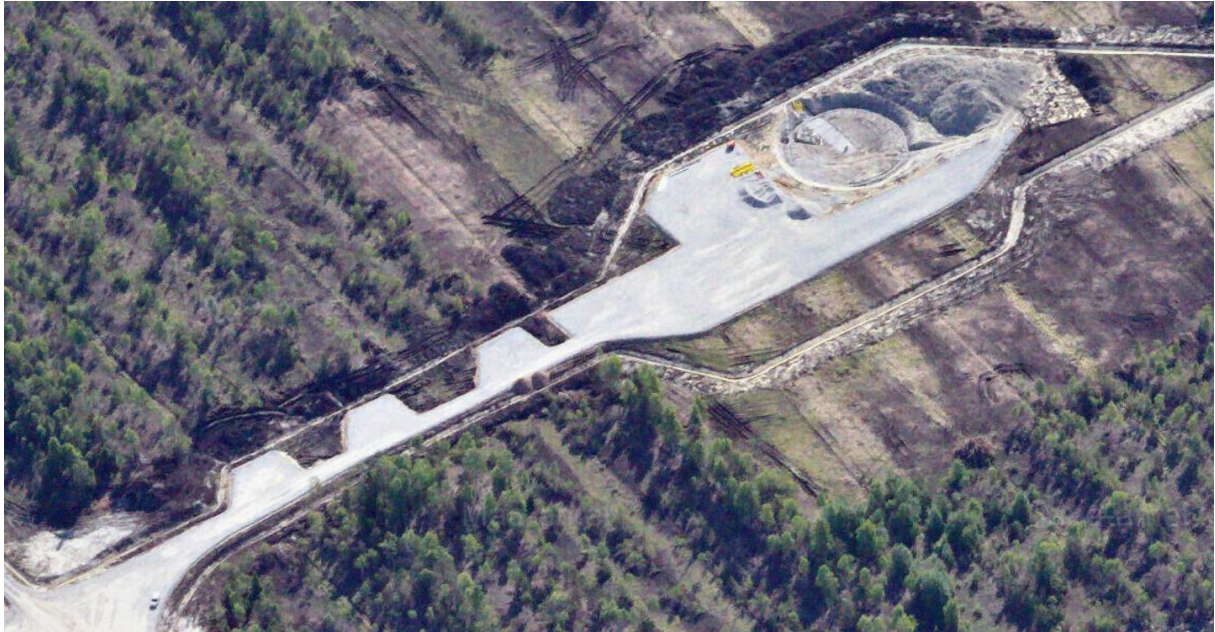
Joonis 5. Võimalik tuuliku vundamendi ala koos montaažiplatsidega. Allikas: Maa-amet Kaldaerofoto – Tootsi/Sopi tuulepark.
