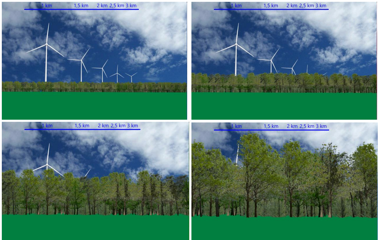
Joonis 76. 270 m kõrgused tuulikud 1, 1,5, 2, 2,5 ja 3 km kaugusel ning illustreeritud on kui 20 m kõrgune mets paikneb vaatajast vastavalt 50, 100, 250 ja 500 m kaugusel.
